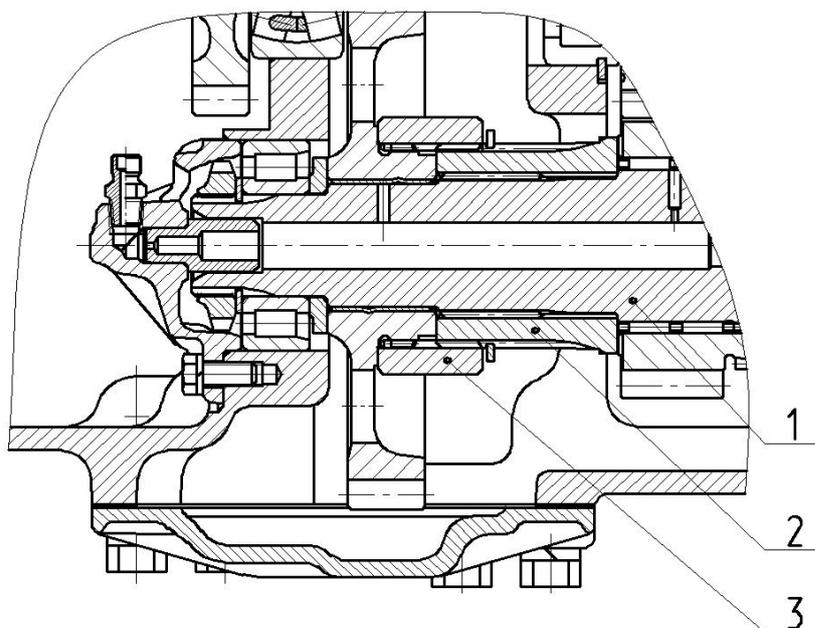
**Рис 2. Вал пониженных передач
