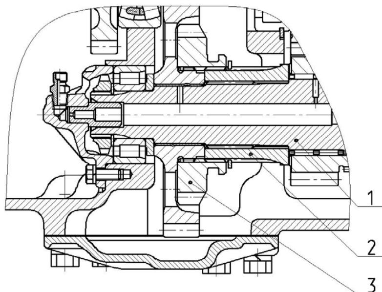
**Рис 1. Вал пониженных передач
