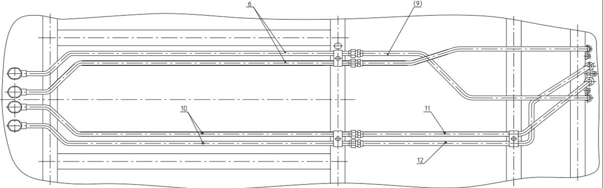
1 - OSPC 315 ON 150-1049 насос-дозатор; 2 - 1221В-3407150 кран реверса; 3 - 40-4607038-А-01 шайба; 4 - 1522В-3407100-07 рукав высокого давления; 5 - 1522В-3407100-06 рукав высокого давления; 6 - 3022В-3407075-01 маслопровод; 7 - 70-1405089 штуцер ввертный; 8 - 017-021-25-1-4 кольцо; 9 - 3022В-3407090 маслопровод; 10 - 3022В-3407075 маслопровод; 11 - 3022В-3407080 маслопровод; 12 - 3022В-3407070 маслопровод; 13 - 3022В-3407018 кронштейн; 14 - 10 ОТ шайба; 15 - М10-6gx20.88.35.019 болт.
