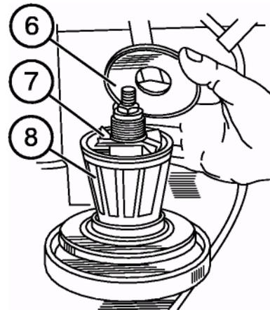
**NOTA:** Después de la parada del motor diesel durante 30-60 segundos debe ser audible el ruido del rotor que gira. Esto indica que el filtro trabaja normalmente.
