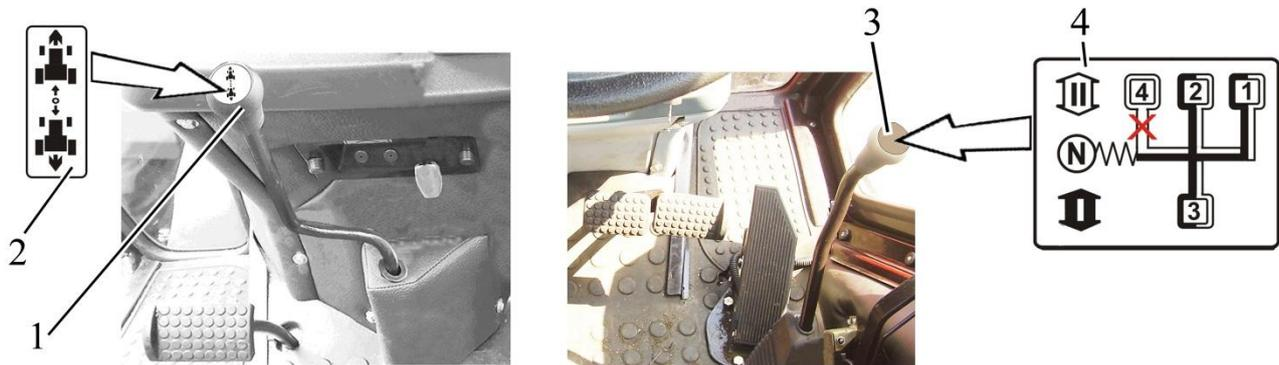
1 – levier de commande de l'inverseur-réducteur; 2 – schéma de changement de degré de l'inverseur-réducteur; 3 – levier de changement de diapason et de vitesse de la BV; 4 – schéma de changement de diapason et de vitesse de la BV.
