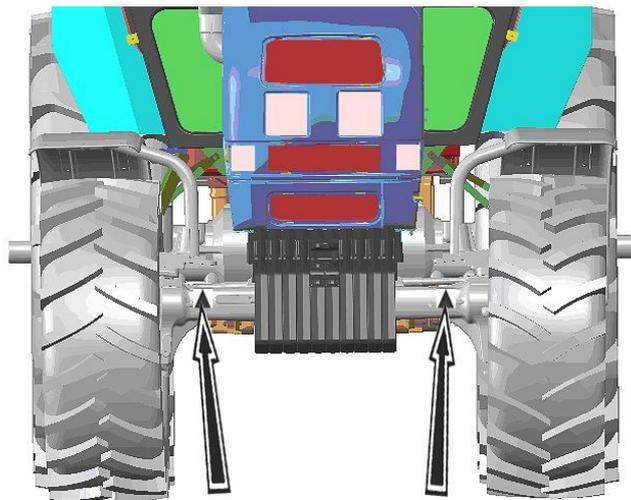
Figure 5.6.3 – Schéma d'installation des crics lors de la montée de la partie avant du tracteur
