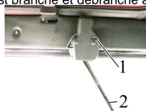
1 – interrupteur à levier; 2 – levier de l'essuie-glace du verre arrière.
