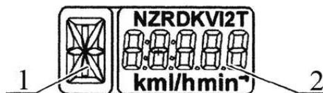
1 – désignation chiffrée de position du commutateur de la boîte de vitesses (chiffres de 0 à 6) ou désignation littérale de position du commutateur du réducteur (lettres L, M, H, N);
