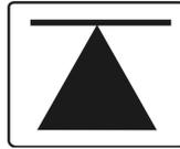
Figure 5.6.1 – Signe du point d'installation du cric
