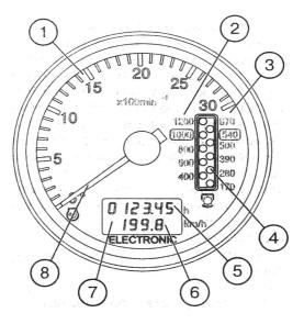
Fig. 1. Tachospeedometer (P1):
