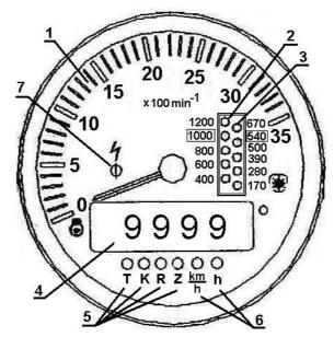
Fig. 4. Tachospeedometer (P1):
